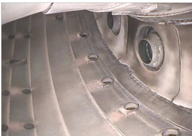
Камера сгорания авиационного двигателя
