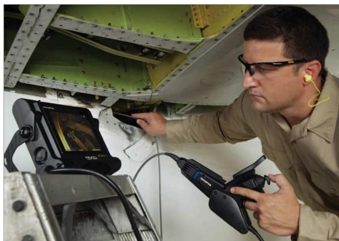
Для установки на поверхности IPLEX RX используется поворотная обрезиненная рукоятка
