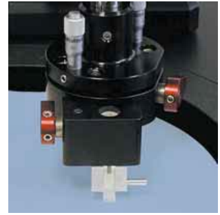
Вставка из боросиликатного стекла полируется параллельно абразивной поверхности
