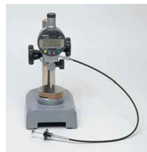
Проверьте толщину с помощью цифровой контрольно-измерительной системы № 120-30010
