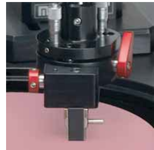
Не залитый электронный блок, приклеенный на держатель образцов
