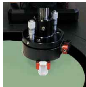
Образец утонен с помощью алмазной пленки
