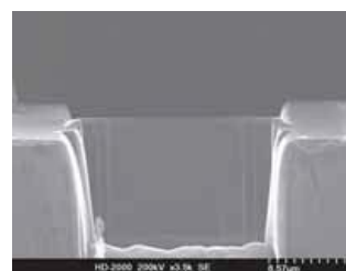
Подготовленное с помощью сфокусированного ионного пучка тонкое сечение для просвечивающей электронной микроскопии (предоставлено Hitachi)
