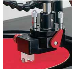
Интегральная схема на одном кристалле, приклеенная на держатель образцов для выполнения поперечных сечений
