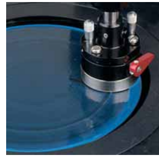
Образец соприкасается с коллоидным диоксидом кремния
