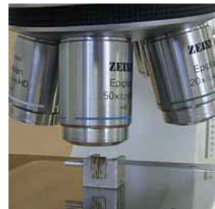
Низкопрофильный держатель удобен для просмотра образцов на микроскопе
