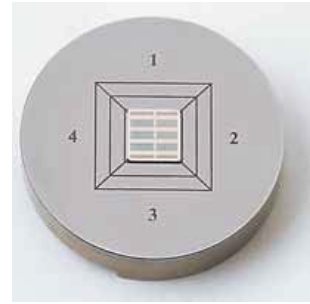
Интегральная схема приклеена на держатель (размер образца: 14 x 14 мм)
