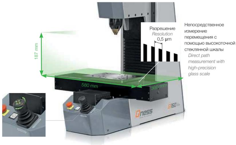
Современная конструкция обеспечивает большое и хорошо продуманное пространство. Полностью автоматический XY-стол с высокоточной оптической системой измерения перемещения может включать 8-позиционный держатель образцов. Помимо этого нестандартные держатели могут быть созданы и управляться с помощью ПО
