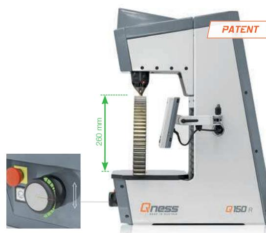
Компактный твердомер в сочетании с электронным контролем перемещения позволяет обеспечить быстрое и точное движение модуля нагружения. Его расположение предотвращает столкновение и обеспечивает точность благодаря углу поворота ручки (6 мм/с).
