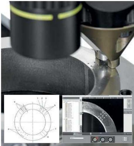
С Q150 A или A +, можно автоматически проверять трубы в соответствии с применимыми стандартами API.
