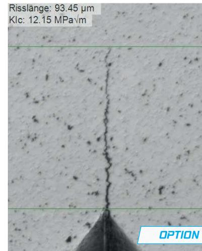
Для оценки величины K1C, измеряются 4 линии трещин в соответствии со стандартом. После этого величина  $MPa\sqrt{m}$  определяется автоматически.
