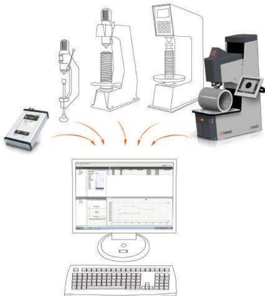
Все данные измерений могут быть переданы со всех систем измерения твердости на Ваш ПК, где эти данные могут централизованно управляться и обрабатываться. По запросу могут быть присоединены и другие внешние устройства.
