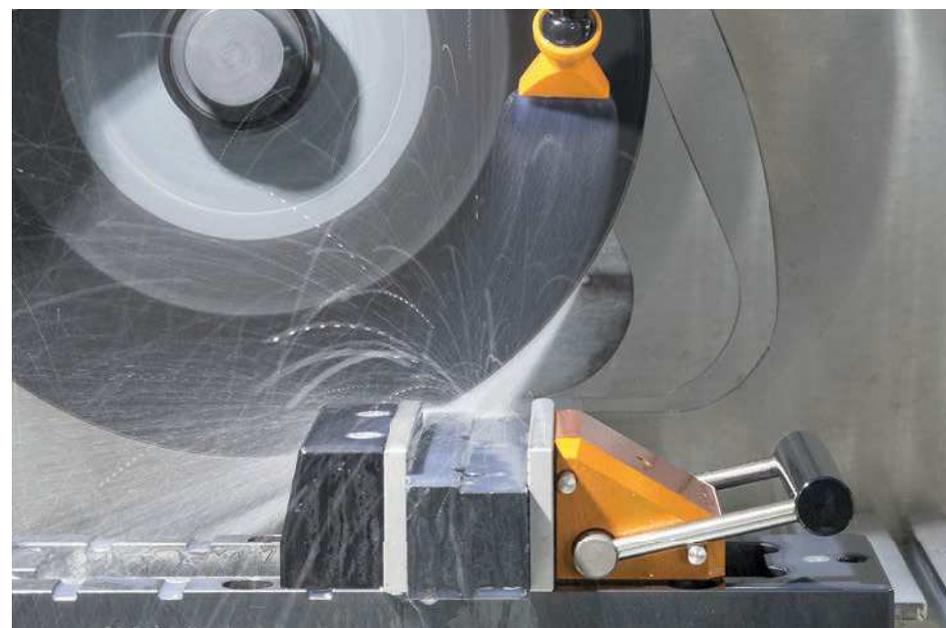
Зажимное устройство Qness в действии. Форсунки для идеального охлаждения места отрезного диска и заготовки. Стружка вымывается эффективно.
