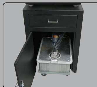
Вид внутри. Внешняя система поддачи СОЖ (5-5700-ER)
