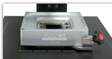
Крепление X-Prep® установлено в адаптере на моторизованном столе X-Prep® Vision™
