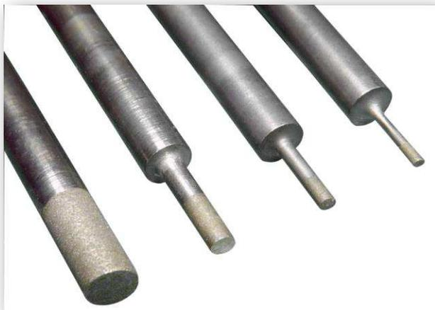
Стержень из твёрдого сплава обеспечивает большую жёсткость, чем стальные инструменты: благодаря этому уменьшаются отклонения, и обеспечивается более высокая точность позиционирования.
