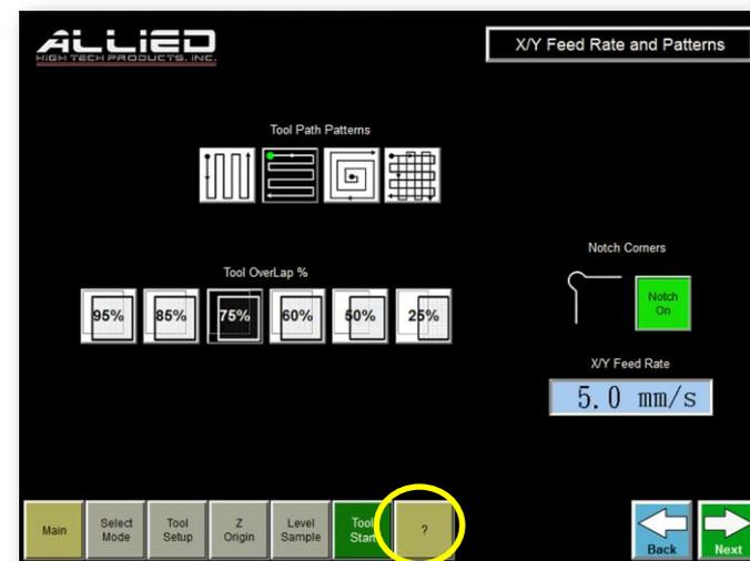
Кнопка вызова помощи (?) в каждом окне предоставляет конкретные инструкции для оператора
