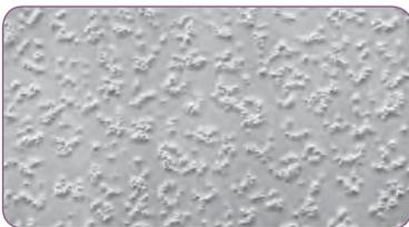
Изображение под электронным микроскопом, 6 нм, стандартная прикладная алмазная пленка, при увеличении 150X
