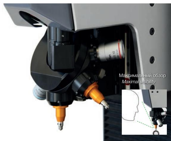
6-позиционная автотурель стандартна для всех моделей и обеспечивает возможности для различных методов испытаний. Например, она может быть снабжена 3 различными объективами и соответствующими инденторами для измерений по методам Виккерса, Кнупа или Бринелля.
