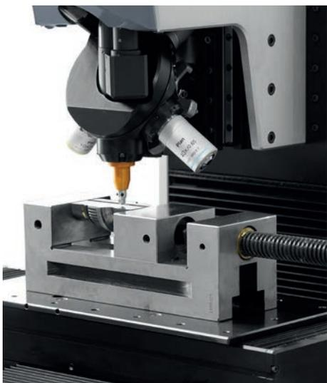
Отлично просматриваемая и четко спроектированная рабочая зона делает решение более универсальным. В дополнение к этому, непосредственный зажим образцов в тисках снижает трудозатраты на пробоподготовку и расширяет возможности применения в области измерения твердости в будущем.
