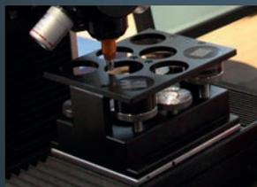
Полностью автоматическое тестирование: создаются несколько серий и образцов, которые обрабатываются в автоматическом режиме (например, 60 серий на 8 различных образцах на одном измерительном пробеге)
