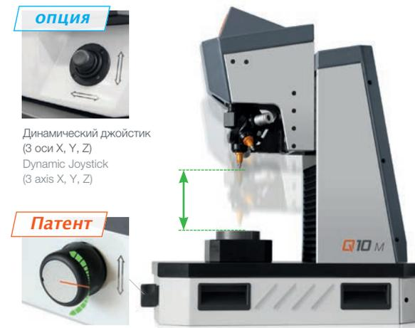
Электронное управление передвижением (регулировка рабочей высоты по оси Z) позволяет выполнять быстрое, точное и интуитивное движение измерительного модуля „головы“. Бессилое, отзывчивое и защищенное от столкновения позиционирование углом поворота ручки (скорость движения по оси Z от 0,01 до 20 мм/с).
