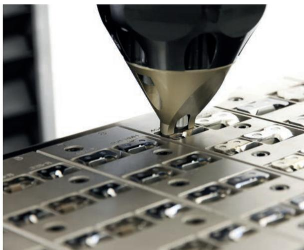
Серии измерений идентичных образцов могут быть сохранены в качестве шаблонов. Предопределенные магазины для размещения образцов могут быть использованы для активации соответствующих данных, таких как расположение тестовых точек, методы измерения и пользовательские поля.
