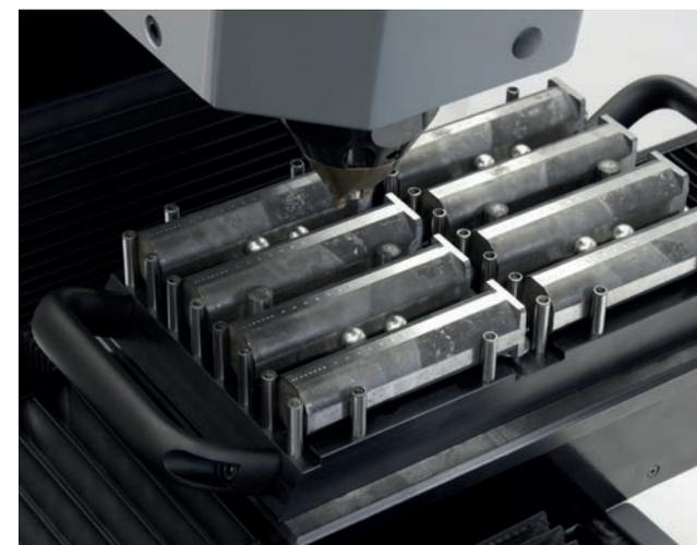
До 8 образцов могут быть помещены в держатель для измерения по Джомини. Измерительный цикл полностью автоматический и выполняется в соответствии со стандартом.
