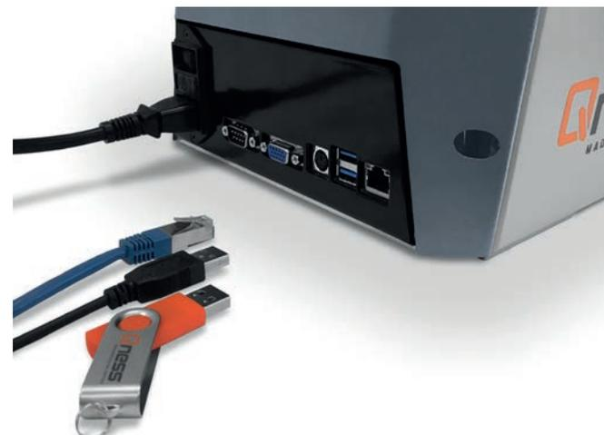
Полная интеграция в сеть и высокая производительность на основе встроенного ПК с SSD диском даже в базовой модели Q150R в стандартной комплектации. Кастомизированные решения для передачи данных и встраивание в производственную линию возможны по запросу.
