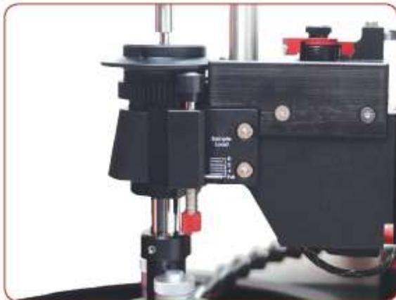
Система зубчатого привода рекомендуется для подготовки более крупных, твердых, прочных или инкапсулированных материалов. Она обеспечивает нескользящее вращение в случаях более высоких нагрузок.
