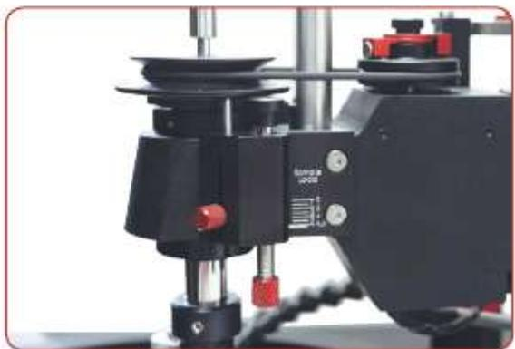
Ременный привод (через резиновое кольцо) больше подходит для подготовки тонких, сложных, деликатных, неинкапсулированных материалов, обычно связанных с утонением образца в форме клина для просвечивающей электронной микроскопии ТЕМ. Ременный привод способен поглощать крутильные колебания и рывки, которые в противном случае могли бы вызвать разрушение материала образца.
