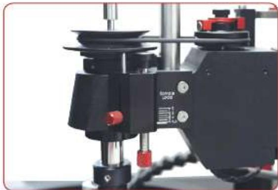
Ременный привод (через резиновое кольцо) больше подходит для подготовки тонких, сложных, деликатных, неинкапсулированных материалов, обычно связанных с утонением образца в форме клина для просвечивающей электронной микроскопии TEM. Ременный привод способен поглощать крутильные колебания и рывки, которые в противном случае могли бы вызвать разрушение материала образца.
