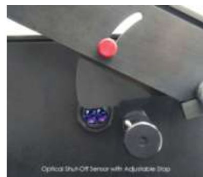
Оптический датчик автоматического отключения с настраиваемой глубиной остановки
