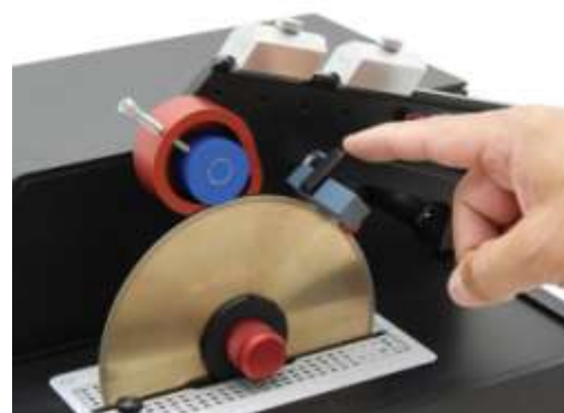
Выравнивающий брусок позволяет зачищать диск прямо во время резки
