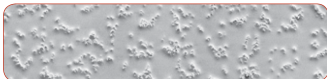
Изображение с СЭМ, 6 мкм стандартная пленка (150×)
