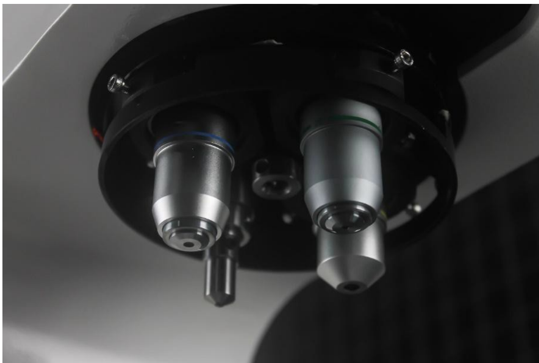
Конструкция турели с одним индентором и тремя объективами
